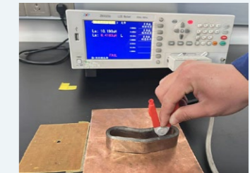
10kHz 0.3V L=10.2μH 100kHz 0.3V L=8.5μH
